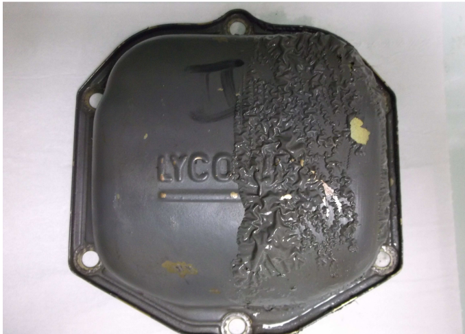
Décapage peinture d'une pièce aéronautique
