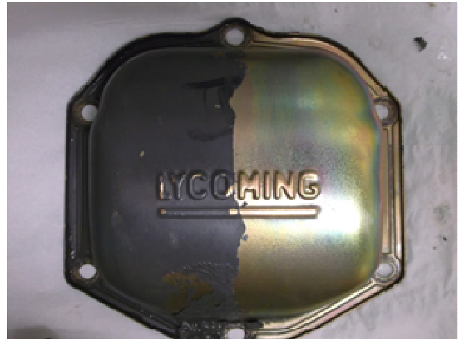
Décapage peinture d'une pièce aéronautique
